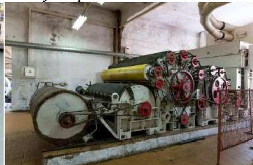
Процесс изготовления валенок требует физической силы, громоздкого оборудования, выдержки и терпения. Основными этапами процесса считаются: мытье шерсти, рыхление и чесание, формирование валенка, валяние и создание формы, сушка, придание товарного вида.
