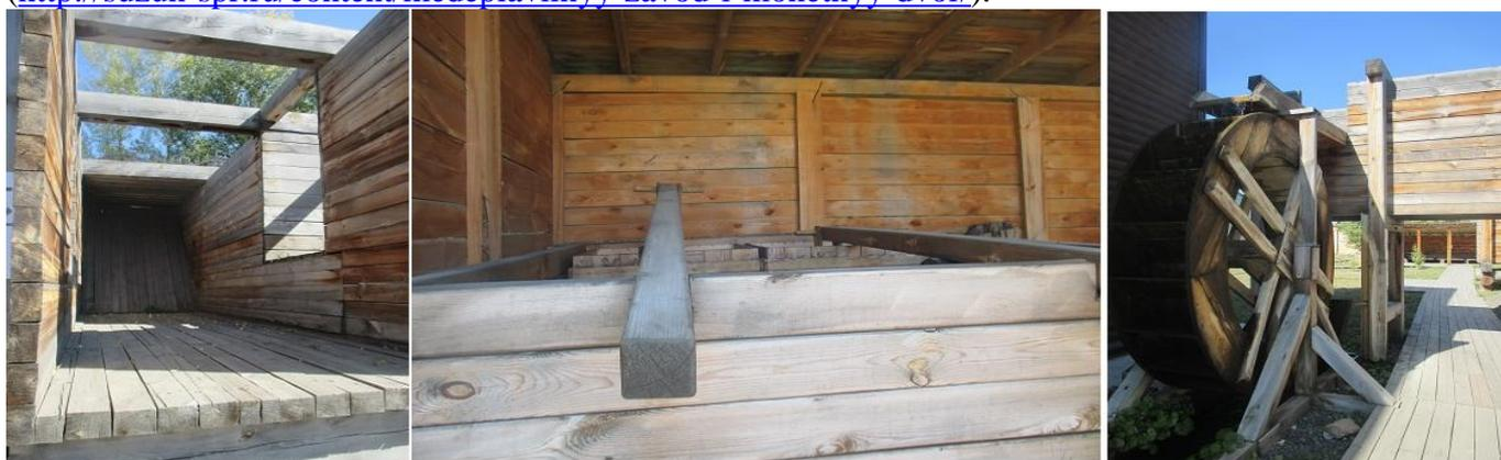
На улице можно увидеть полноразмерную реконструкцию капитального ларя с водоотводящими рукавами (вверху слева), меха ящичного типа (вверху в центре) и действующий макет водоналивного колеса. Фрагменты ларя были найдены в ходе археологических работ.
