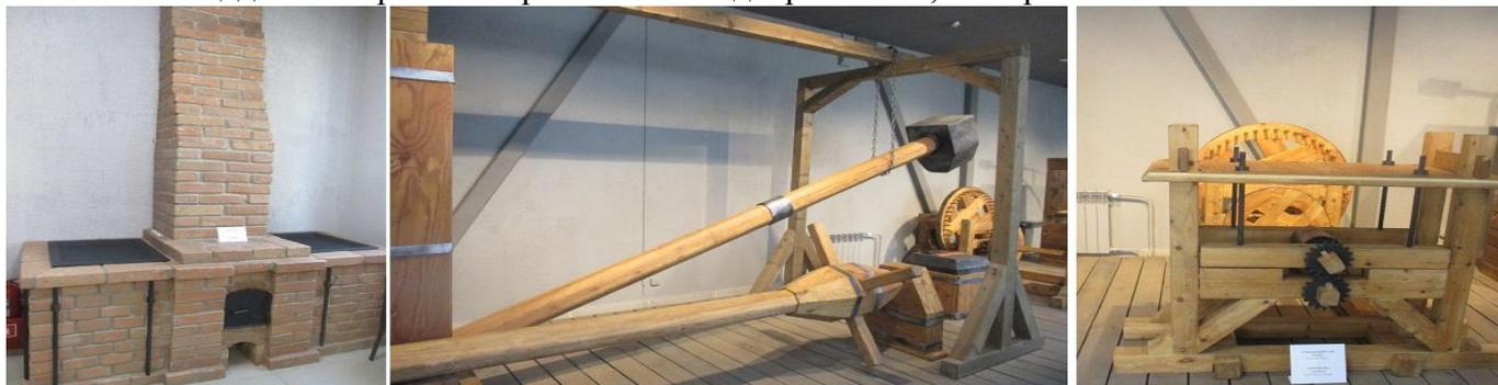
На монетном дворе Сузуна расковывали штыки (слитки) в полосы, прокатывали до нужной толщины (такая операция называлась плащение), вырезали медные кружки, которые отжигали в специальных сковородах со щелочью, затем гуртили и чеканили изображения. Все медные отходы вновь сплавлялись и использовались повторно.
